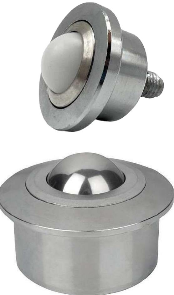
Шариковая опора – это механизм для организации свободного перемещения нагрузки с большой площадью опоры. Как правило, устанавливается, как один из компонентов в устройства перемещения. Состоит из стального или пластикового шара, который лежит на «подушке» из маленьких шариков, и все они заключены в (обычно) стальной корпус. За счет качения основного шара по маленьким минимизируется сопротивление среды при перемещении тяжелых грузов.
